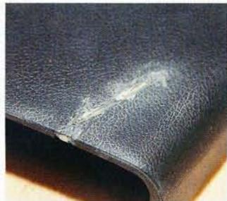
Auf die Vorderseite tupfen wir Füllmasse. Die Struktur wird...
