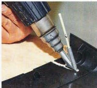
Mit Heißluft und Schweißschuh wird Material eingeschmolzen
