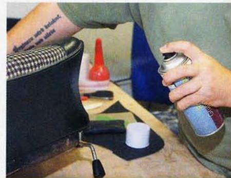
Zum Schluss wird nass in nass grundiert und mit passender Kunststofffarbe lackiert
