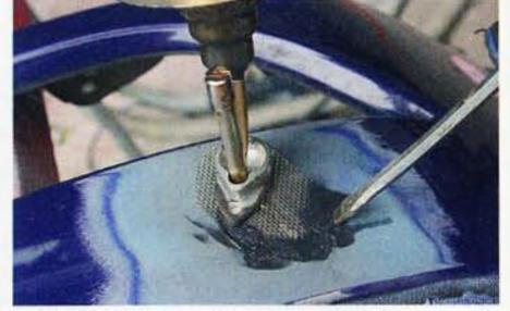
...die als Bügeleisen fungiert und bei 260 Grad Heißluft die Stahlmatte einschmelzen lässt
