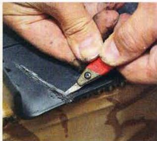
Die Bruchstelle wird auf der Rückseite V-förmig erweitert
