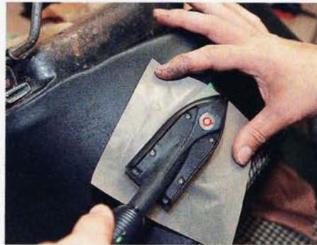
Das heiße Bügeleisen (170 Grad) beschleunigt die Trocknung. Teflonfolie schützt das Pad
