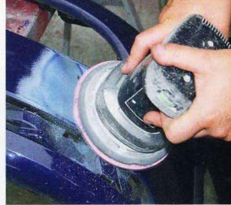
Mit Körnung 120 wird der Lack entfernt und die Polypropylen-Oberfläche angeraut
