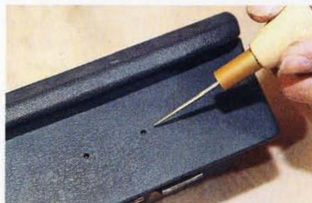
Bohrlöcher adé: Der Glanzgrad der Oberfläche sollte noch mit feinem Schliff (Stahlwolle) sowie Lackierung angepasst werden
