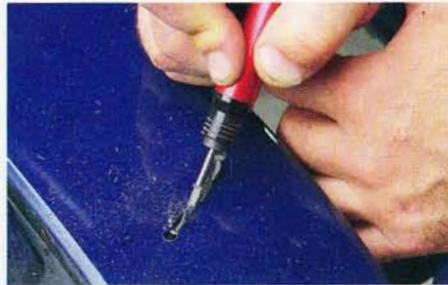
Um die Bruchstelle zu entspannen, fräst man sie auf und setzt Bohrlöcher an den Enden
