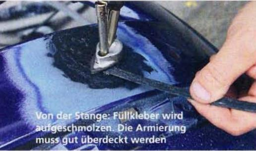
Von der Stange: Füllkleber wird aufgeschmolzen. Die Armierung muss gut überdeckt werden
